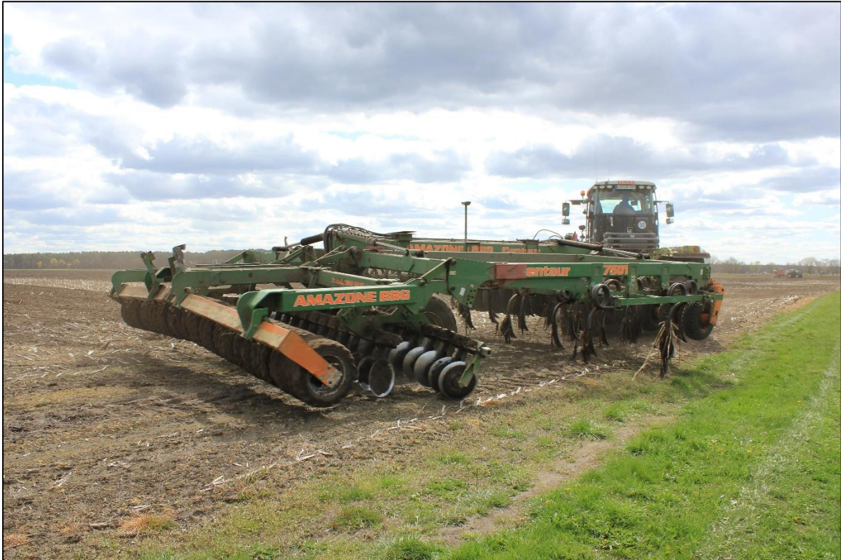
Abb. 3: Saatbettvorbereitung mit Grubber/Scheibenegge/Walze (26.04.2021, Foto A. Schöps)
